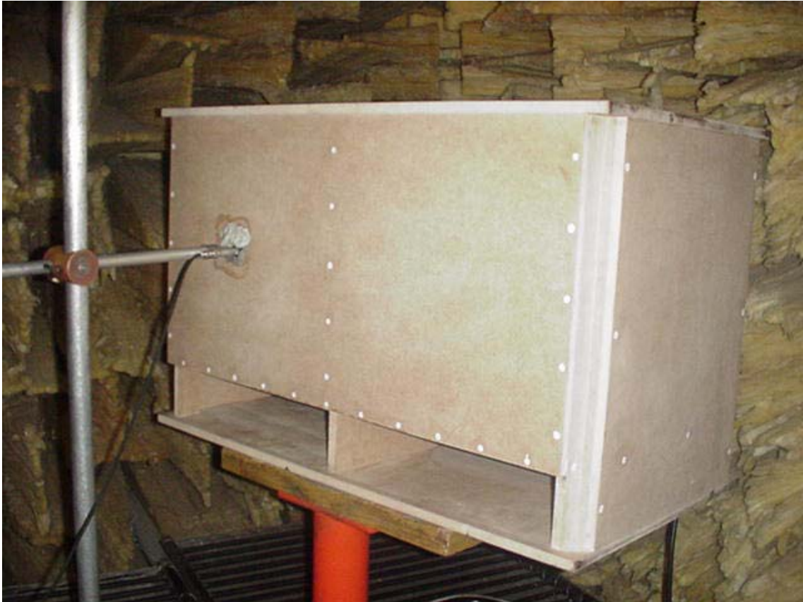
Fig. 84 – Caixa Band Pass de 4ª ordem, dupla, durante a medição da pressão acústica, na câmara selada.
