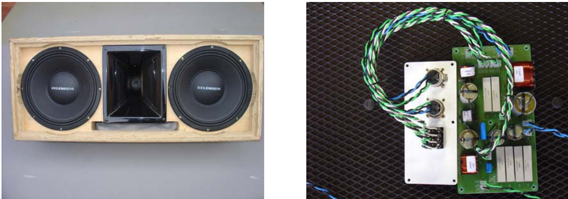
Fig. 16 - Fotos da caixa protótipo e do seu divisor passivo.
