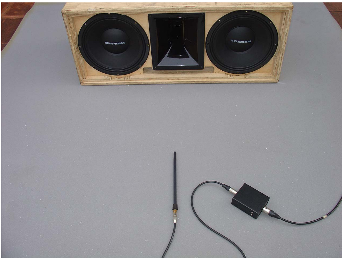
Fig. 22 – Posição da caixa e do microfone para a medição da resposta em frequência
