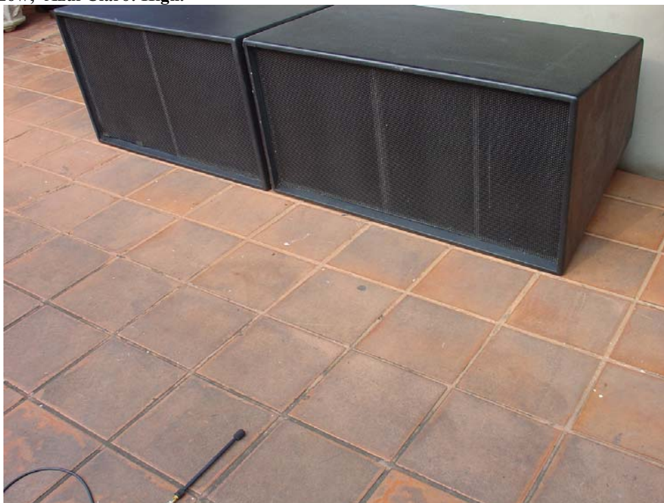
Método utilizado para medir a resposta do conjunto PAS3 – Opção 3 – O microfone deve ser posicionado a 2 metros de distância da caixa. Ver Fig. 23.
