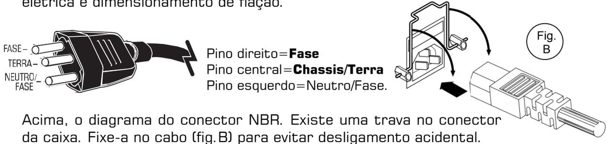
Acima, o diagrama do conector NBR. Existe uma trava no conector da caixa. Fixe-a no cabo (fig.B) para evitar desligamento acidental.
